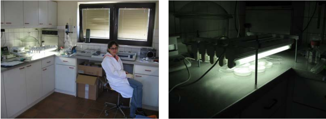
Abbildung 5: Belichtung von UV-bestrahlten Proben des Ablaufes der Kläranlage mit der Laboranlage für Photoreaktivierung im Betriebslabor der ARA Podersdorf
